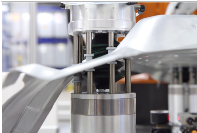
Автоматизированный захват и фиксация детали с помощью присоски и баланс-системы SSCB
